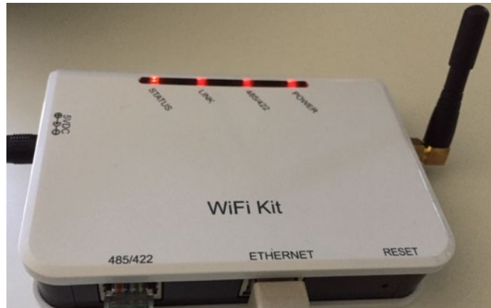
Figura 75 – LED che indica la corretta configurazione del datalogger
