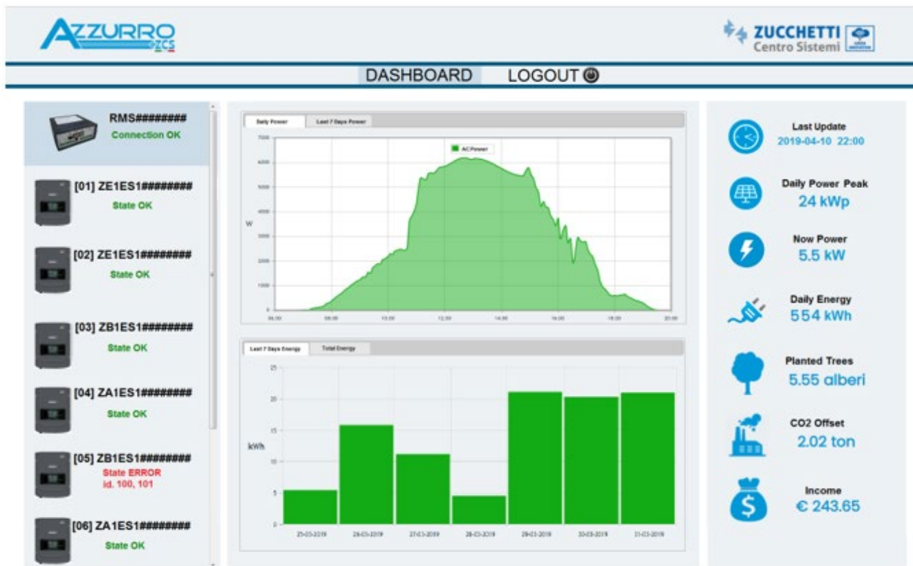
Figura 80: Esempio di pagina di monitoraggio locale
