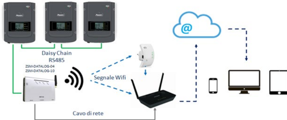
Figura 52 – Schema per il collegamento del datalogger ZSM-DATALOG-04 / ZSM-DATALOG-10
